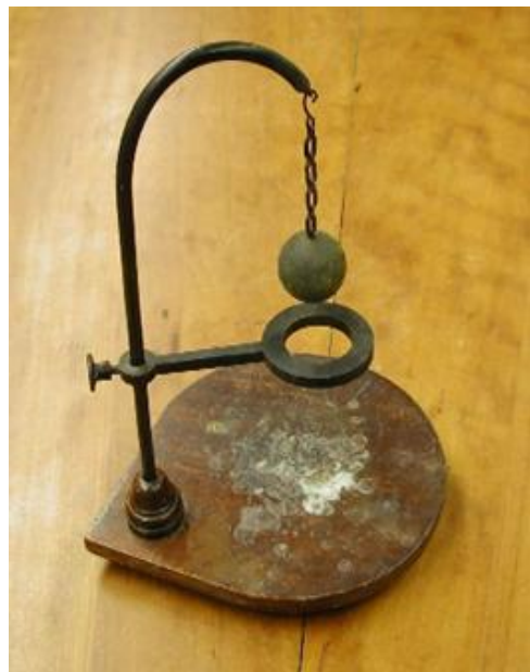
Afbeelding 28: Originele opstelling voor de proef 'Bol en ring van 's Gravesande' [Boerhaave Museum]
